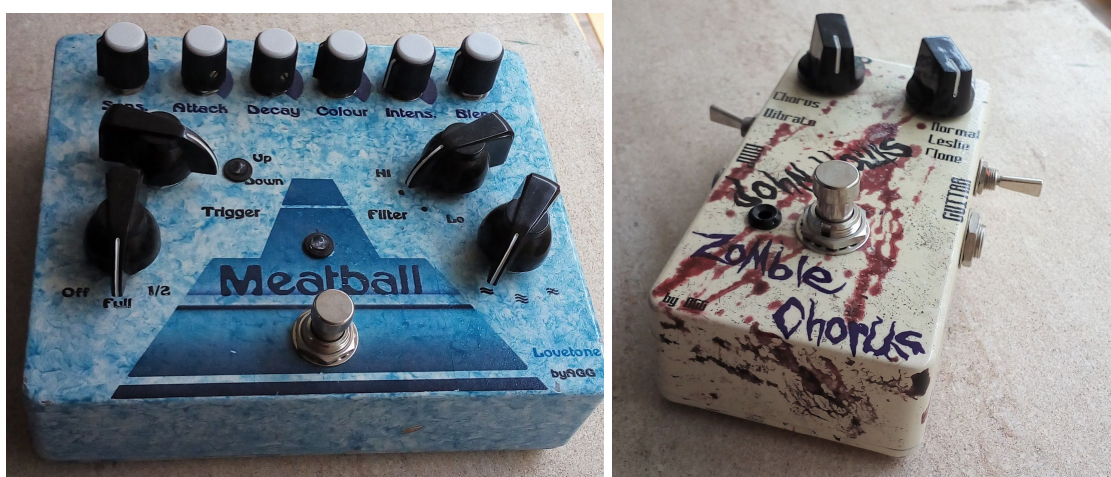
Figura 4: Izquierda: Réplica del autowah Lovetone Meatball, usando el proyecto McMeat de http://www.experimentalistsanonymous.com . Derecha: Pedal de chorus analógico construido según la web www.pisotones.com .
