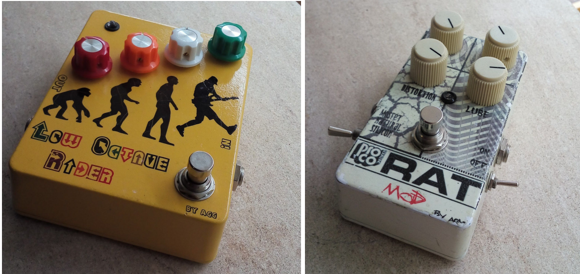
Figura 3: Izquierda: Octavador LowRider, diseñado y documentado en www.madbeanpedals.com . Derecha: Réplica modificada de la distorsión Proco Rat. Procedente de www.tonepad.com .
